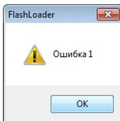
Надо проверить коммуникационный кабель, соединяющий RS232 и контроллер, на предмет его правильного подключения.
